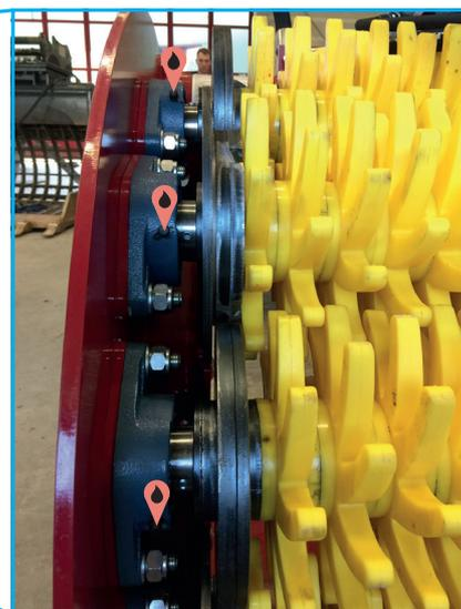
**Graissez les paliers de rouleaux d'entraînement des deux côtés 1 à 2 fois par jour avec 1 à 2 coup de pompe à graissage!**
