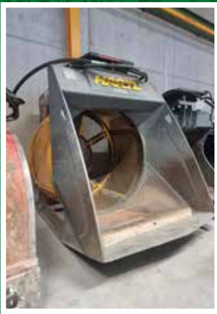
Sieblöffel / Godet cribleur HBS 1200 1220 kg 13-21 t 2014
