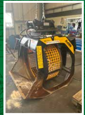
Sieblöffel / Godet cribleur MB S14 S4 1100 kg 9-20 t 2022
