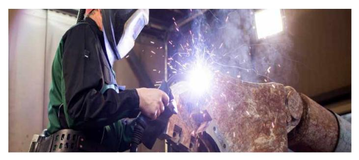
Wir sind spezialisiert in der Regeneration und Reparatur von Abbruchzangen und Scheren. Dies umfasst allgemeine Revisionsarbeiten sowie das fachgerechte Aufschweissen der Gebisse und die korrekte Aufbereitung der Messer.
